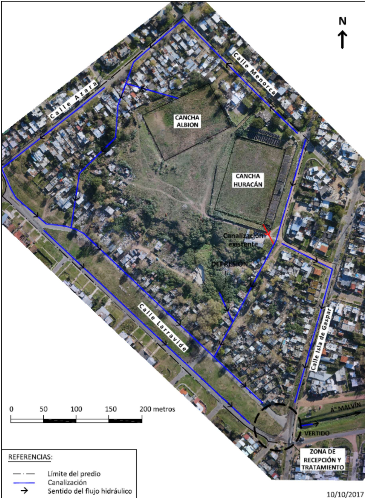
Propuesta de desagüe pluvial. Esquema conceptual para el predio.
