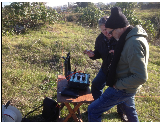
Figura 2. Realizando la Tomografía Sísmica 1
