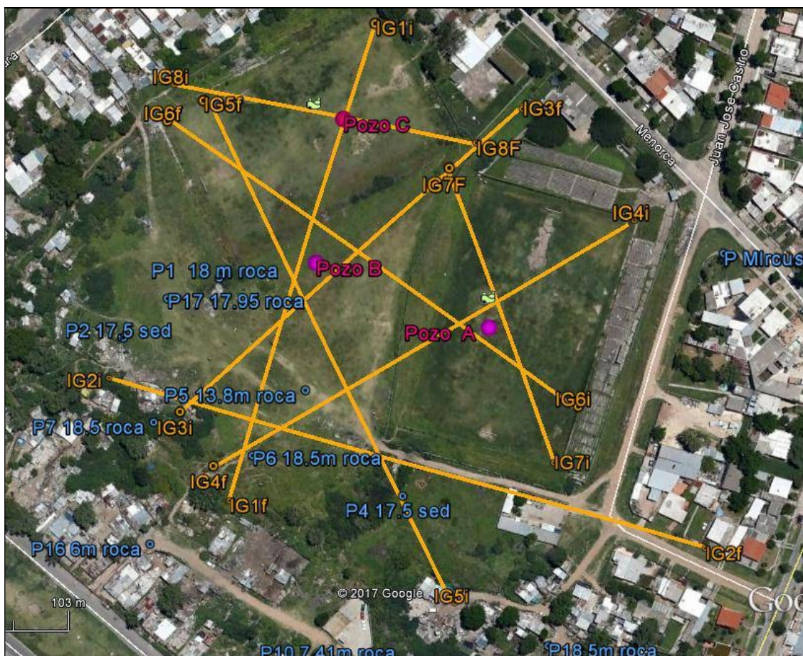
Figura 20 En ámbar se muestra la ubicación de las TE. En azul los pozos conocidos. En rojo los pozos propuestos que nos ayudarían a calibrar la interpretación.
