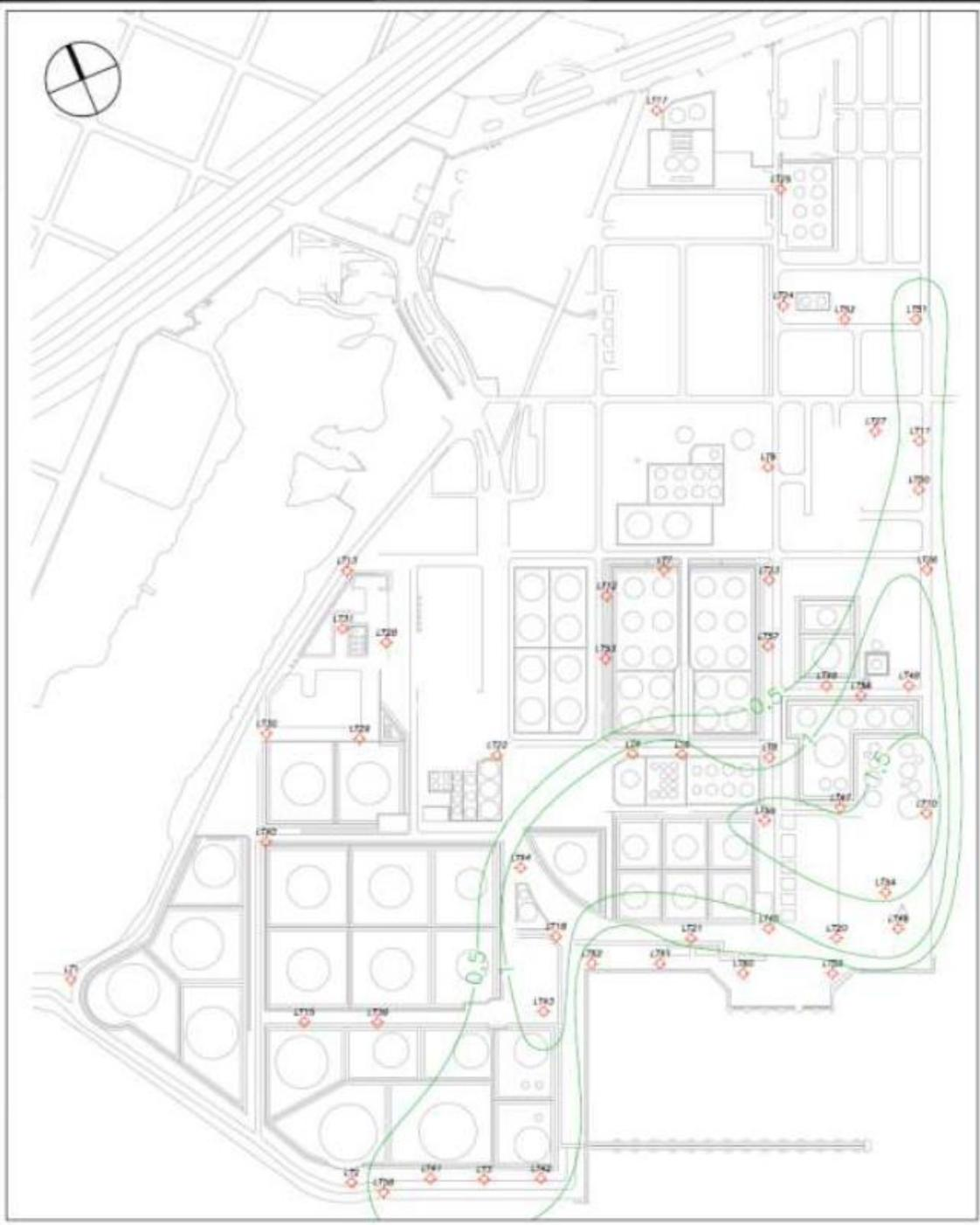
Curva de Isoespesores Planta La Teja
