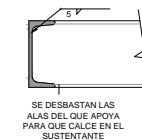
DETALLE 04 | Apoyo viga sobre viga
